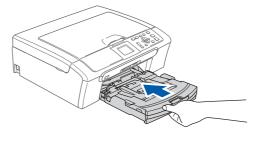
将纸盒装入到位的同时拉出纸张支撑板
