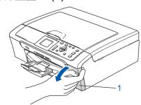
3 将所有锁定释放杆压下并移去黄色保护 部件 (1)。
