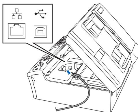
**4** Guidez soigneusement le câble réseau dans la rainure comme indiqué ci-dessous, en suivant celle-ci autour et vers l'arrière de l'appareil. Connectez ensuite le câble à votre réseau.
