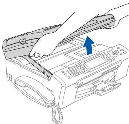
**11** Reliez le câble USB à la prise USB repérée par le symbole . La prise USB se trouve à l'intérieur de l'appareil sur la droite, comme indiqué ci-dessous.
