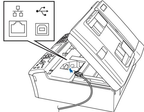
**4** Führen Sie das Kabel vorsichtig - wie gezeigt - durch die Vertiefung zur Rückseite des Gerätes. Schließen Sie das Kabel dann an Ihrem Netzwerk an.
