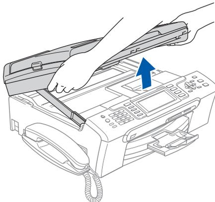
**3** Schließen Sie das Netzkabel am LAN-Anschluss (📶) des Gerätes an. Der LAN-Anschluss befindet sich wie unten gezeigt im Inneren des Gerätes.
