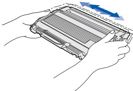
4 Réinstallez l'ensemble tambour et cartouches de toner dans l'appareil.
