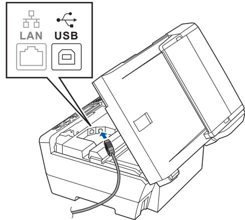
**c** Führen Sie das USB-Kabel vorsichtig - wie gezeigt - durch die Vertiefung zur Rückseite des Gerätes. Schließen Sie es dann am Macintosh® an.
