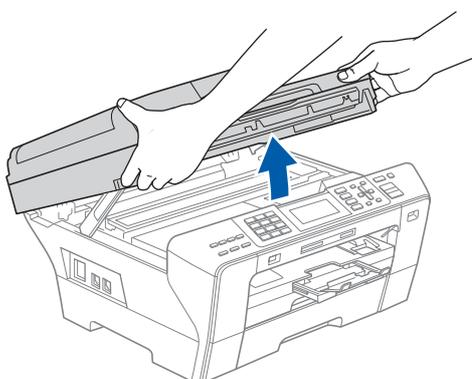
**b** Schließen Sie das USB-Kabel am USB-Anschluss (
