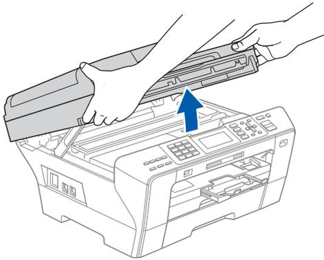
**b** Schließen Sie das USB-Kabel am USB-Anschluss (🔌) des Gerätes an. Der USB-Anschluss befindet sich wie unten gezeigt im Inneren des Gerätes rechts.
