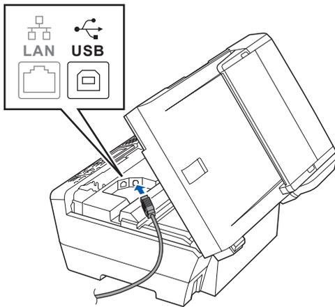
**c** Führen Sie das USB-Kabel - wie gezeigt - vorsichtig durch die Vertiefung zur Rückseite des Gerätes. Schließen Sie es dann am Computer an.
