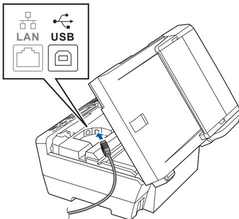
**c** Coloque con cuidado el cable USB a través de la ranura hasta que salga por la parte posterior del equipo, como se muestra a continuación, y conecte el cable al ordenador.
