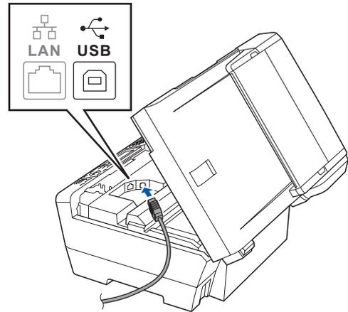
**c** Coloque con cuidado el cable USB a través de la ranura hasta que salga por la parte posterior del equipo, como se muestra a continuación, y conecte el cable al Macintosh®.
