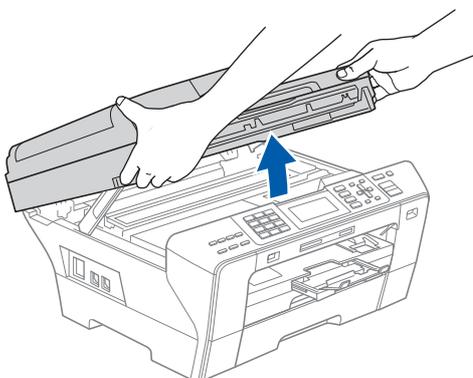
**b** Conecte el cable USB a la conexión USB marcada con el símbolo
