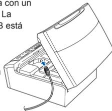
c. Inserte con cuidado el cable USB en el canal de cables hacia la parte trasera del equipo. Conecte el cable al ordenador.
