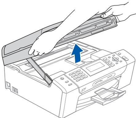
**b** Schließen Sie das USB-Kabel am USB-Anschluss (
