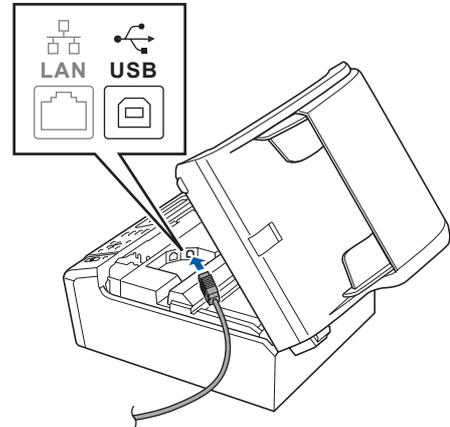
**c** Führen Sie das USB-Kabel vorsichtig - wie gezeigt - durch die Vertiefung zur Rückseite des Gerätes. Schließen Sie es dann am Macintosh® an.
