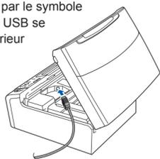
c. Guidez soigneusement le câble USB dans la rainure et faites-le sortir par l'arrière de l'appareil. Connectez ensuite le câble à l'ordinateur.
