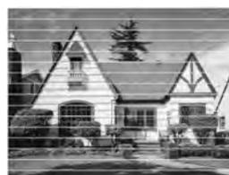
Quando um bocal da cabeça de impressão estiver bloqueado, a amostra impressa assemelha-se a isto.
