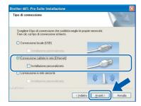
Per gli utenti di Windows<sup>®</sup> XP SP2/Windows Vista<sup>®</sup>, quando appare questa schermata, scegliere Modificare le impostazioni della porta Firewall per attivare la connessione in rete e procedere con l'installazione.
