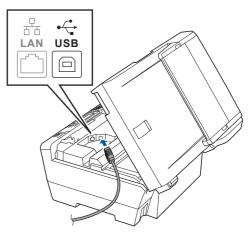
Prestando la dovuta attenzione, far passare il cavo USB nella canalina come mostrato di seguito, disponendo il cavo intorno e verso il lato posteriore dell'apparecchio. Quindi, collegare il cavo al Macintosh<sup>®</sup>.
