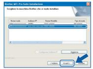
Se nel campo **Indirizzo IP** viene visualizzata l'indicazione **APIPA**, fare clic su **Configurare Indirizzo IP** e specificare per l'apparecchio un indirizzo IP adatto alla rete in uso.
