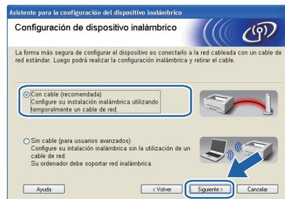
**i** Conecte el dispositivo inalámbrico Brother (la impresora) al punto de acceso mediante un cable de red y haga clic en **Siguiente**.
