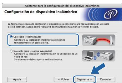
**i** Conecte el dispositivo inalámbrico Brother (la impresora) al punto de acceso mediante un cable de red y haga clic en **Siguiente**.
