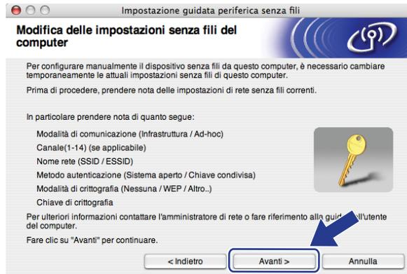
Se si desidera configurare la macchina per la rete wireless in uso, annotare le impostazioni di rete wireless prima della configurazione. Controllare e registrare le impostazioni della rete wireless correnti
