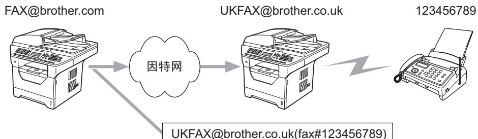
在此例中，您的设备拥有一个名为 FAX@brother.com 的电子邮件地址，若想从此设备发送一份文档至位于英国的电子邮件地址为 UKFAX@brother.co.uk 的设备，本设备将通过常规电话线将文档转发至一台标准传真设备。如果您的电子邮件地址是 FAX@brother.com，您必须为位于英国的设备配置名为 brother.com 的信任域名，此设备将多址发送文档至传统传真设备。如果您未输入域名信息，则中间设备（多址发送文档的设备）将不会确认任何从域为 @brother.com 接收到的网络作业。
