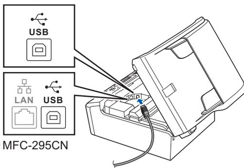
**c** Guidez soigneusement le câble USB à travers la rainure comme indiqué ci-dessous, en suivant celle-ci autour et vers l'arrière de l'appareil. Connectez ensuite le câble à l'ordinateur.
