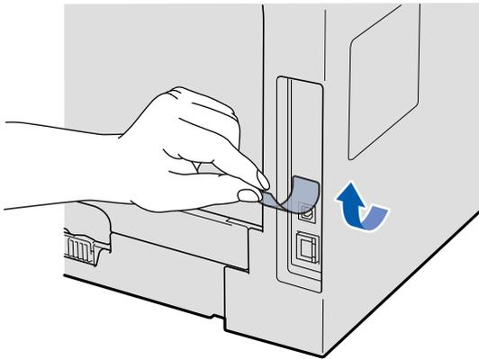
**b** Raccordez le câble USB au connecteur USB de la machine identifié par le symbole
