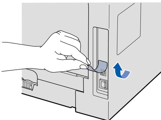
**b** Raccordez le câble USB au connecteur USB de la machine identifié par le symbole . Ensuite, raccordez le câble à votre ordinateur.
