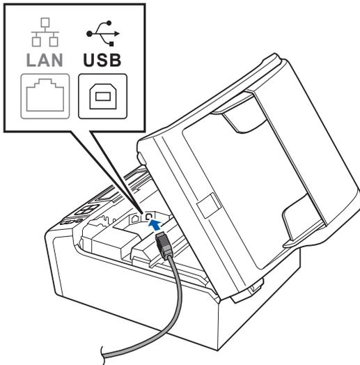
**c** 小心地將 USB 線穿過溝槽 (如下圖所示)，並沿著溝槽將 USB 線繞到設備後面，然後插入您的電腦。
