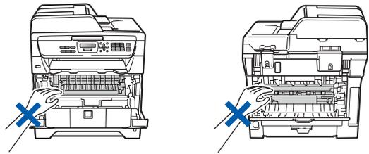
Pour éviter toute blessure corporelle, prenez soin de ne pas placer les mains sur le bord de l'appareil sous le capot document ou sous le capot du scanner comme illustré.
