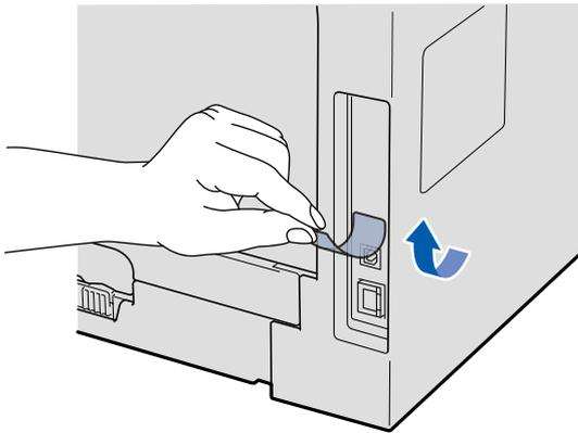
**b** Raccordez le câble USB au connecteur USB de la machine identifié par le symbole
