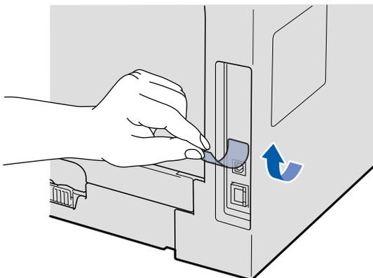
**b** Raccordez le câble USB au connecteur USB de la machine identifié par le symbole
