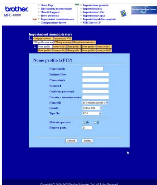
È possibile modificare Modalità passiva su No o su Sì, in base alla configurazione del server FTP e del firewall di rete in uso. Per impostazione predefinita questo parametro è impostato su No. È inoltre possibile modificare il numero di porta utilizzato per accedere al server FTP. L'impostazione predefinita è la porta 21. Nella maggior parte dei casi, è possibile mantenere le impostazioni predefinite per questi due parametri.
