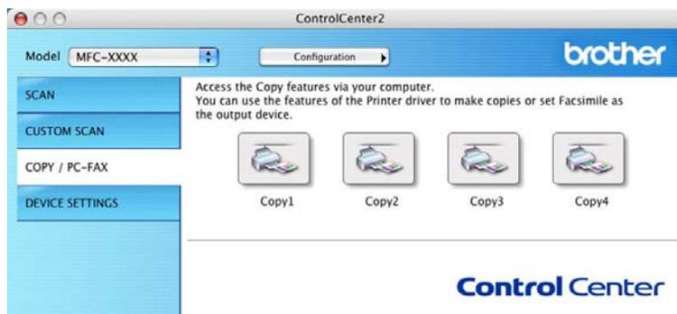
Для использования кнопок **Copy** (Копирование) настройте драйвер принтера, нажав кнопку и удерживая нажатой клавишу **Ctrl**.
