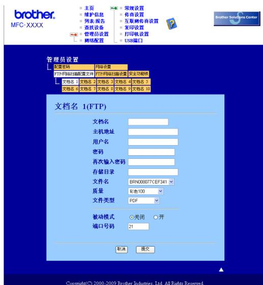
您可以根据 FTP 服务器和网络防火墙的配置将被动模式设定为开或关。默认设置为关。您还可以更改用于访问 FTP 服务器的端口号。默认设置为端口 21。在大多数情况下，可以保留上述两项设置的默认设置。
