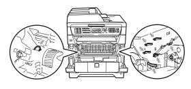
3 Нажмите вниз синий рычаг блокировки и извлеките использованный тонер-картридж из фотобарабана.
