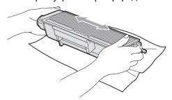
6 Снимите защитную крышку.
