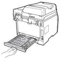
2 Вытяните замятую бумагу из аппарата или модуля двусторонней печати.
