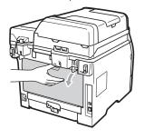
2 <Только для печати на конвертах> Потяните два синих рычага слева и справа вниз и на себя, как показано на рисунке ниже.
