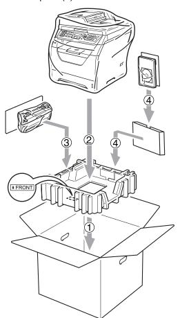
9 Возьмите два пенопластовых блока и совместите переднюю часть аппарата с отметкой "FRONT" на одном из блоков, а заднюю часть – с отметкой "REAR" другого блока (5). Сверните кабели и поместите их и руководство по быстрой установке в соответствующие места, как показано ниже (6).
