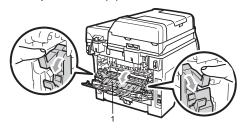
6 Вытяните замятую бумагу из узла термозакрепления.
