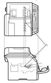
Установите блок фотобарабана с тонер-картриджем на место.
