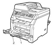
5 Удерживая нажатым рычаг отпускания направляющей для бумаги, отрегулируйте положение направляющих согласно формату используемой бумаги.
