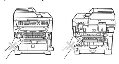
1 Нажмите кнопку фиксации передней крышки и откройте переднюю крышку.
