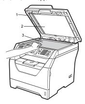
3 В блоке автоподатчика очистите белую пластиковую полосу (1) и расположенную под ней полоску стекла сканера (2) мягкой безворсовой тканью, смоченной в воде.
