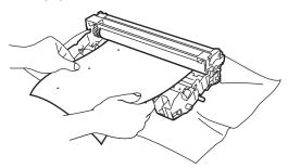
5 Рукой поворачивайте механизм редуктора фотобарабана, глядя на поверхность светочувствительного барабана (1).
