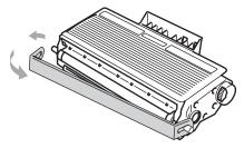
6 Установите новый тонер-картридж в фотобарабан до фиксации со щелчком. При правильной установке рычаг фиксатора автоматически поднимется.
