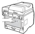
5 Потяните на себя лапки, расположенные слева и справа, и откиньте крышку узла термического закрепления (1).
