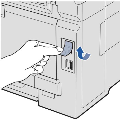
**b** Insérez le câble USB dans le connecteur USB de l'appareil identifié par le symbole
