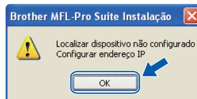
Clique em **OK** e, em seguida, em **Configurar endereço IP**. Introduza um endereço IP para o aparelho, que seja adequado à rede, seguindo as instruções na tela.
