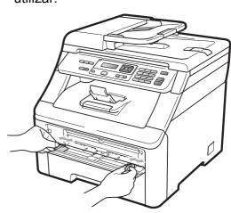
4 Com as duas mãos, coloque uma folha de papel na ranhura de alimentação manual com a face a imprimir virada para cima até a margem dianteira tocar no rolo do alimentador de papel. Aguarde até o aparelho alimentar automaticamente o papel. Quando sentir o aparelho a puxar o papel, largue-o.
