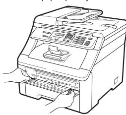
4 Con las dos manos, inserte una hoja de papel en la ranura de alimentación manual con el lado donde se va a imprimir boca arriba hasta que el borde delantero del papel toque el rodillo de alimentación del papel. Espere hasta que el equipo cargue automáticamente el papel. Cuando note que el papel entra en el equipo, suéltelo.
