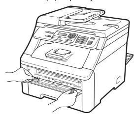
5 Con las dos manos, inserte una hoja de papel o un sobre en la ranura de alimentación manual hasta que el borde delantero del papel o del sobre toque el rodillo de alimentación del papel.
