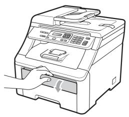
Utilice las dos manos para deslizar las guías del papel de la ranura de alimentación manual para acomodar el ancho del papel que vaya a utilizar.
