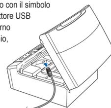
c. Prestando la dovuta attenzione, inserire il cavo USB nell'apposita canalina fino all'uscita sul retro dell'apparecchio. Collegare il cavo al computer.
