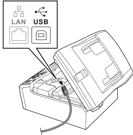
**c** Faites passer soigneusement le câble USB à travers la rainure, faites-le sortir par l'arrière de l'appareil et branchez-le à votre ordinateur.
