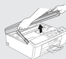
b. Ligue o cabo USB à tomada USB assinalada com o símbolo . A tomada USB encontra-se no interior do aparelho como indica a figura.
