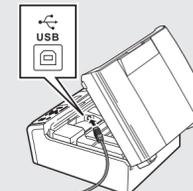
c. Passe cuidadosamente o cabo USB através da calha e para fora da parte de trás do aparelho. Ligue o cabo ao Macintosh.
