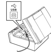
c. Passe cuidadosamente o cabo USB através da calha e para fora da parte de trás do aparelho. Ligue o cabo ao computador.
