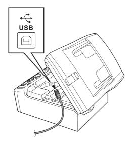
Prestando la dovuta attenzione, far passare il cavo USB nella canalina come mostrato di seguito, disponendo il cavo intorno e verso il lato posteriore dell'apparecchio. Quindi, collegare il cavo al computer.
