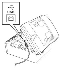
Prestando la dovuta attenzione, far passare il cavo USB nella canalina come mostrato di seguito, disponendo il cavo intorno e verso il lato posteriore dell'apparecchio. Quindi, collegare il cavo al Macintosh.
