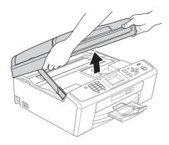
Collegare il cavo USB al connettore USB contrassegnato con il simbolo . Il connettore USB si trova all'interno dell'apparecchio, come illustrato qui di seguito.
