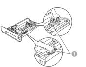
**d.** 将纸张装入纸盒,并确保: ■ 纸张位于最大纸张容量标记
