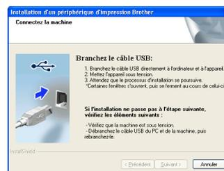
**d** Raccordez le câble USB au connecteur USB de l'appareil portant le symbole
