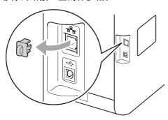
答 将网络接口电缆一端连接到标有器标记的网络接口上,然后将另一端连接到集线器的闲置端口。
