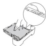
**e.** Insérez fermement le bac à papier dans l'imprimante. Vérifiez qu'il est inséré à fond dans l'imprimante.
