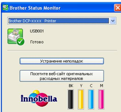
Состояние устройства можно проверить в любое время. Для этого дважды щелкните значок на панели задач или выберите **Status Monitor**, нажав кнопку **пуск** и выбрав пункты **Все программы** и **Brother/MFC-XXXX**.
