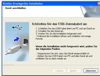
**e** Schließen Sie das USB-Kabel am USB-Anschluss (
