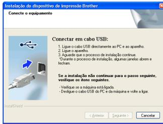
**e** Ligue o cabo USB ao conector USB assinalado com o símbolo
