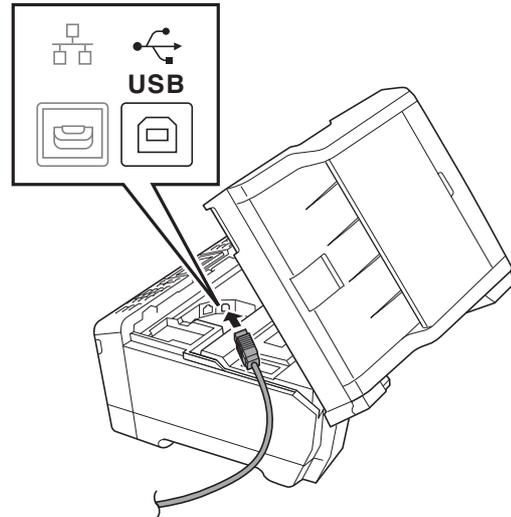
**c** 小心地将 USB 接口电缆嵌入电缆槽内并沿着凹槽绕到设备后部，然后将接口电缆连接到计算机。
