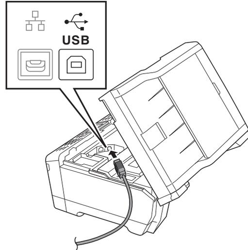
**c** 小心地将 USB 接口电缆嵌入电缆槽内并沿着凹槽绕到设备后部，然后将接口电缆连接到 Macintosh。
