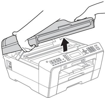
b 如下图所示，可在设备内部的左侧找到 LAN 插口，上面标有
