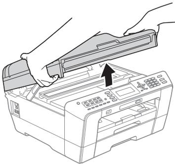
**b** 将 USB 接口电缆一端插入标有
