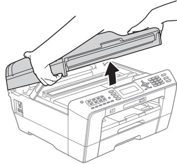
b 如下图所示，可在设备内部的左侧找到 LAN 插口，上面标有
