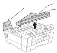
Encontrará la entrada LAN marcada con el símbolo a la izquierda en el interior del equipo, como se muestra en la ilustración. Retire la cubierta de protección y conecte el cable de red a la entrada LAN.
