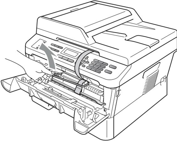
e قم بسحب الشريط الورقي لإزالة المادة الواقية كما هو مبين في الشكل التوضيحي.
