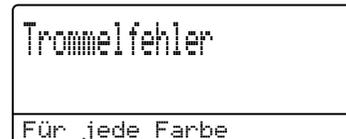
Die Koronadrähte sind verschmutzt. Reinigen Sie die Koronadrähte in der Trommeleinheit. (Siehe *Koronadrähte reinigen* auf Seite 74.)
