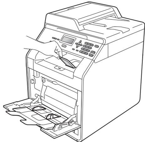
4 Sie können bis zu 3 Umschläge oder bis zu 25 Blatt eines dicken Papiers (163 g/m<sup>2</sup>) in die MF-Zufuhr einlegen. Wenn Sie mehr Umschläge oder Papier einlegen, kann dies einen Papierstau verursachen. Stellen Sie Folgendes sicher:
