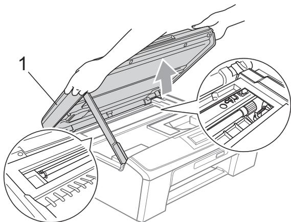
Déplacez la tête d'impression (si nécessaire) pour enlever tout papier restant dans cette zone. Veillez à ce qu'il ne reste aucun morceau de papier coincé dans les coins de l'appareil. Vérifiez les deux extrémités du chariot d'impression.
