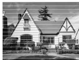
Lorsqu'une buse de tête d'impression est colmatée, voici à quoi ressemble l'échantillon imprimé.
