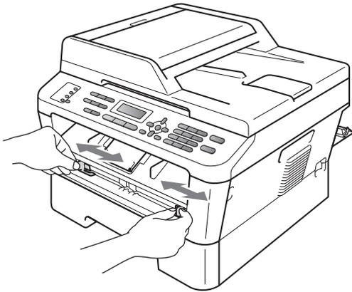
7 Schieben Sie ein Blatt Papier (A4- oder Letter-Format) mit beiden Händen in die manuelle Zufuhr ein, bis die obere Kante des Papiers die Papierzufuhrrolle berührt. Lassen Sie das Papier los, sobald Sie merken, dass es vom Gerät eingezogen wird. Das Gerät startet den Trommelreinigungsvorgang.
