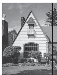
玻璃条上有污点或修正液时，打印样本上出现垂直线条。
