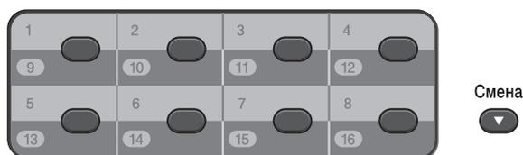
Нажмите клавишу набора одним нажатием, на которой сохранен нужный номер абонента. (См. раздел *Запись в память номеров, набираемых одним нажатием* на стр. 54.) Для набора номеров, записанных в ячейки с 9 по 16, нажмите соответствующую клавишу набора одним нажатием, одновременно удерживая клавишу **Смена**.
