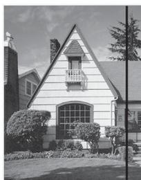
Si hay una mancha de suciedad o restos de líquido corrector en la banda del cristal, la prueba de impresión muestra una línea vertical.
