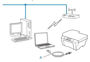
Vous pouvez configurer les paramètres sans fil de l'appareil au moyen d'un câble USB provisoirement connecté à un ordinateur câblé ou sans fil.
