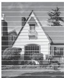
Si un inyector del cabezal de impresión está obstruido, la prueba de impresión tendrá este aspecto.
