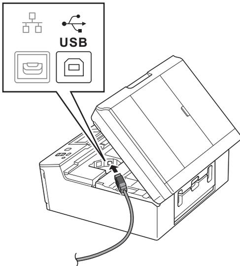
**c** Inserte con cuidado el cable USB en el canal de cables hacia la parte trasera del equipo. Conecte el cable al ordenador.
