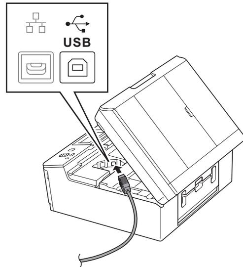
**c** Inserte con cuidado el cable USB en el canal de cables hacia la parte trasera del equipo. Conecte el cable al Macintosh.
