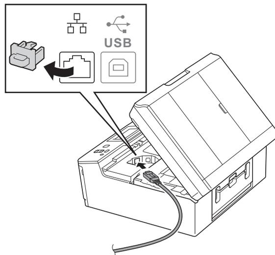
**c** Inserte con cuidado el cable de red en el canal de cables hacia la parte trasera del equipo. Conecte el cable a la red.
